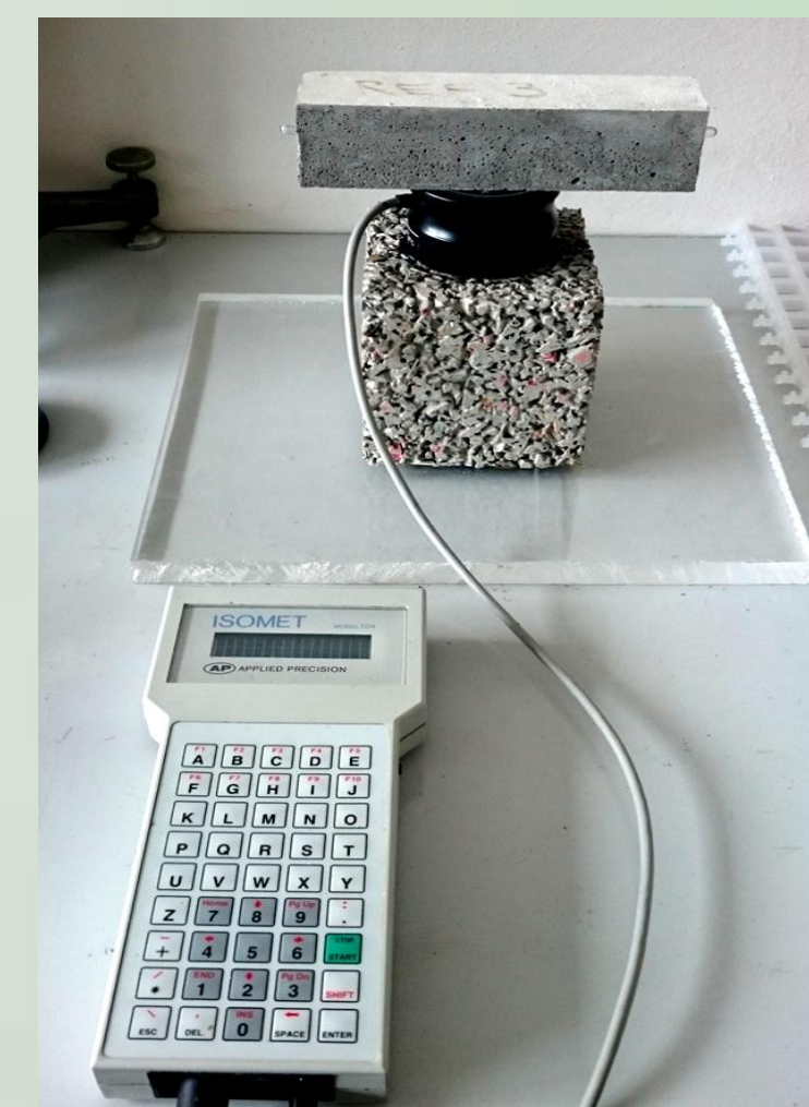
Meranie tepelno-technických vlastností vzorky prístrojom ISOMET
