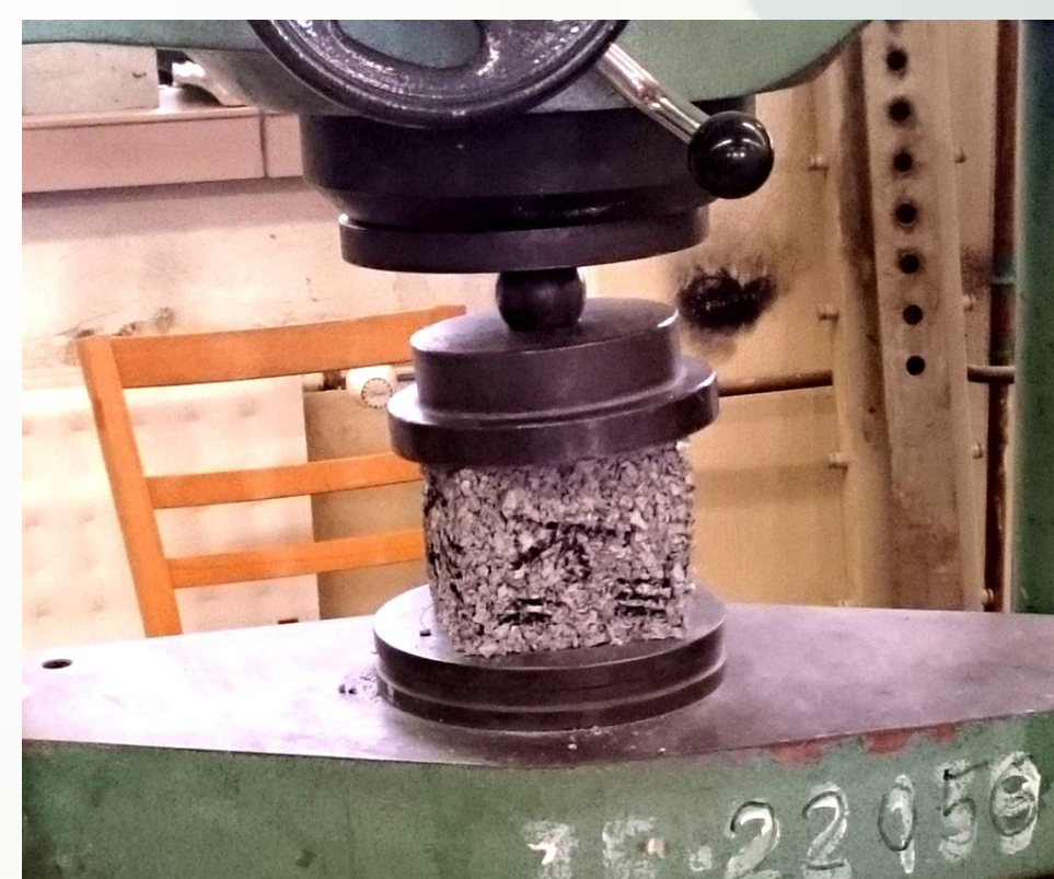
Skúšanie napätia vzorky pri deformácii (10 %)
