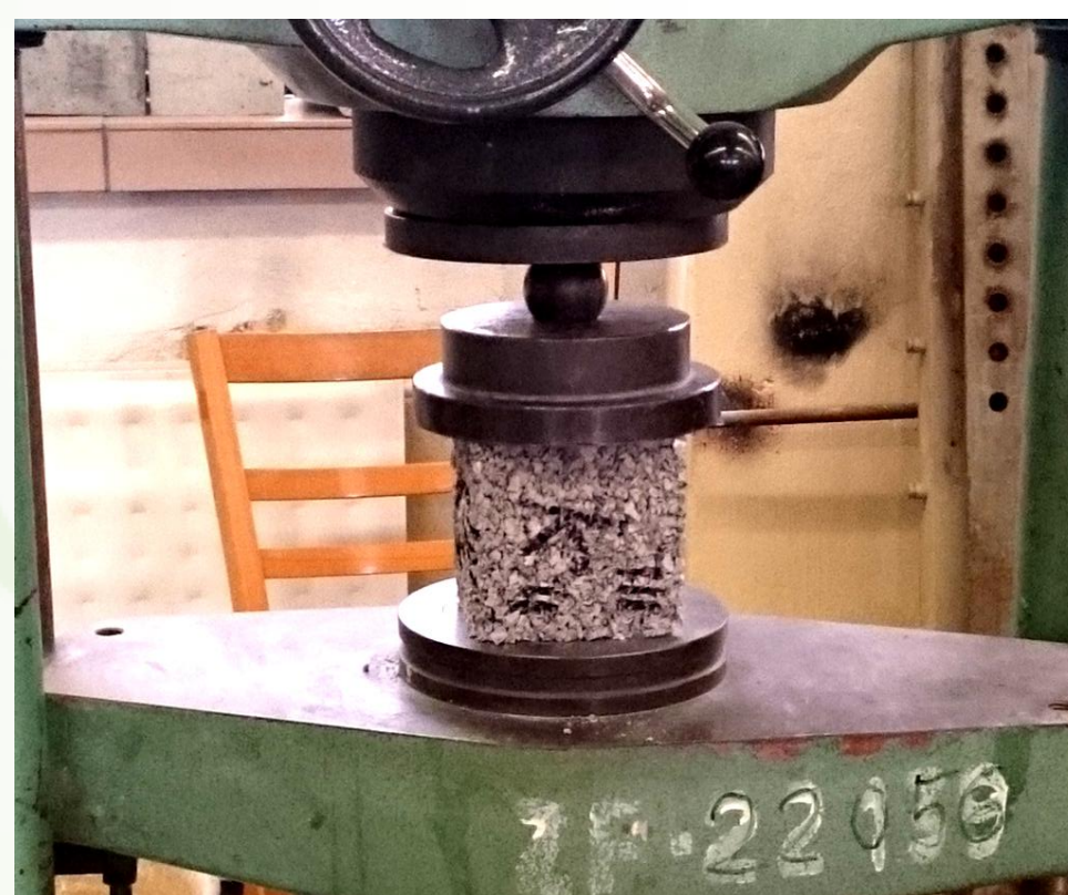
Skúšanie napätia vzorky pri deformácii (2,5 %)
