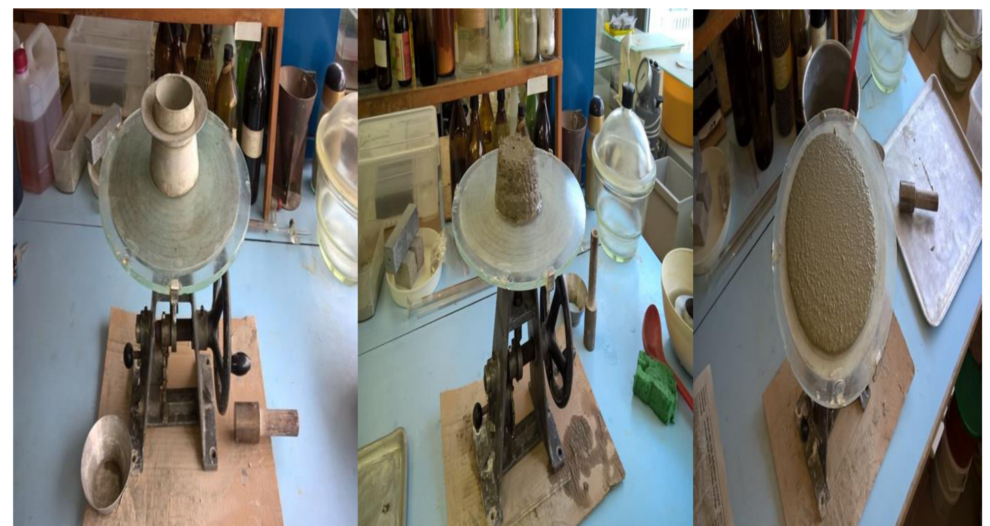
Obr. 3 – Priebeh normovej skúšky cementovej malty za pomoci Haegermannovho stolíka
