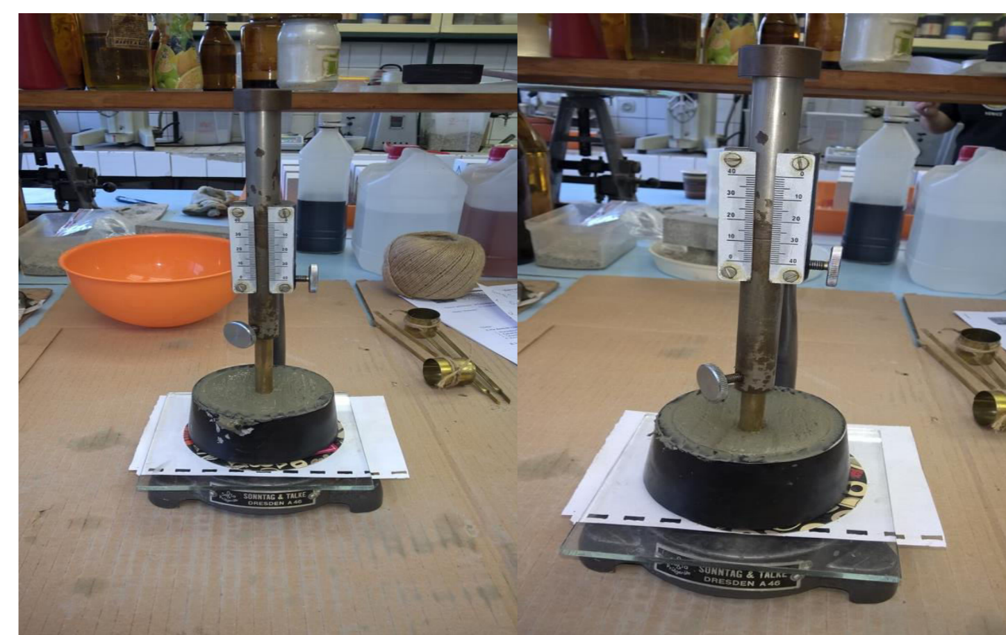
Obr. 4 – Použitie Vicatovho prístroja pri stanovení kaše normálnej hustoty
