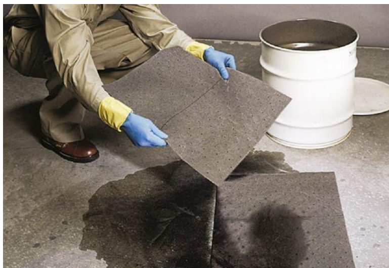
Obrázok 23 Aplikácia textilného sorbentu (15)
