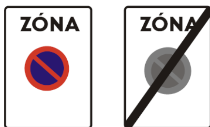
Obr. 24 Informatívne prevádzkové značky IP 24a „Zóna s dopravným obmedzením“ a IP 24b „Koniec zóny s dopravným obmedzením“, dopravné obmedzenie (vzor) - značka B 33
